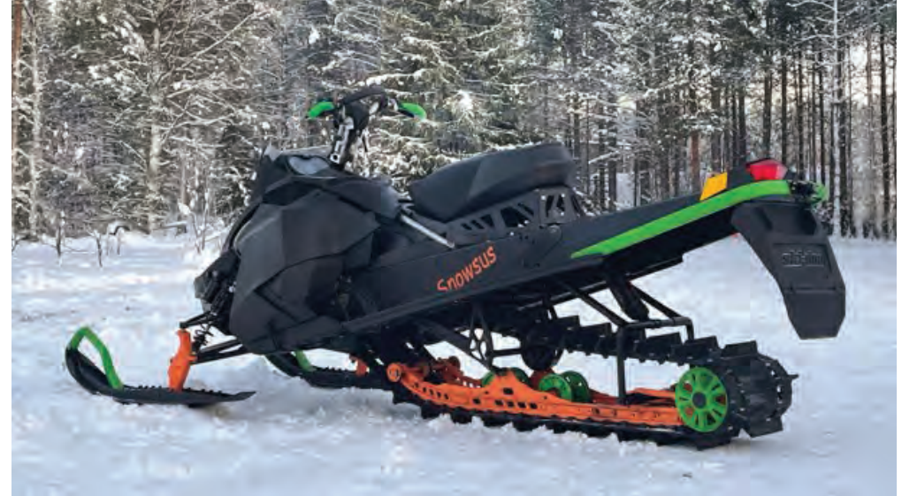
Kuva: Snowsus on innovoinut moottorikelkan jousitukseen aiempaa kevyemmän, metallin 3D-tulostuksella toteutettavan ratkaisun.
