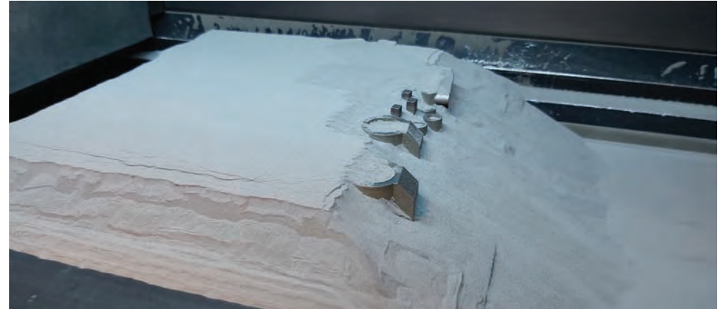
Kuva: Metallitulostusprosessissa tarvitaan kappaleisiin nähden moninkertainen määrä jauhetta.
